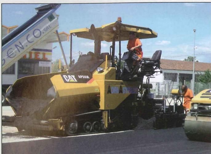
Figura 6 - La grande ventola di raffreddamento posta in posizione frontale allontana i fumi dall'operatore, mentre un sistema di aspirazione li preleva dalla camera della coclea e dai nastri trasportatori convogliandoli nel tubo di scarico
