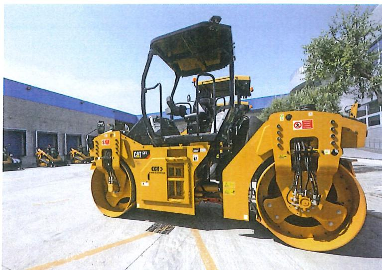
7. Il rullo vibrante tandem Caterpillar CB7 ha peso operativo di 7.990 kg e larghezza di compattazione standard che raggiunge i 1.500 mm
