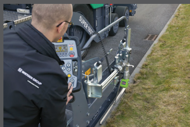
17A e 17B. Il sistema Niveltronic Plus
