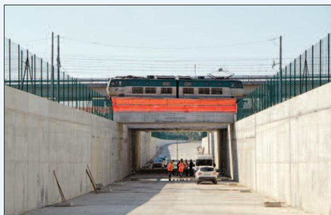
35. La prova di carico sottopasso (opera 2)
